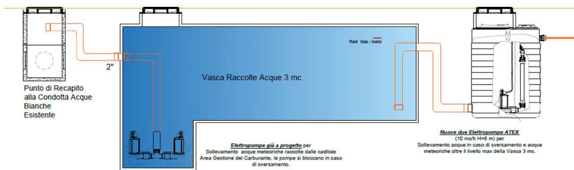
Figura 4.9 – Sistema di rilevazione presenza idrocarburi ed allarme
