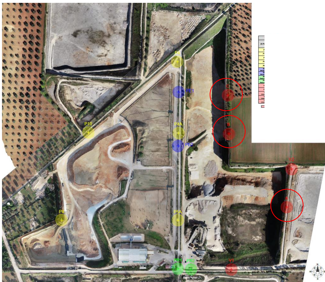
Figura 21: Nuovi pozzi di monitoraggio (cerchiati in rosso)
