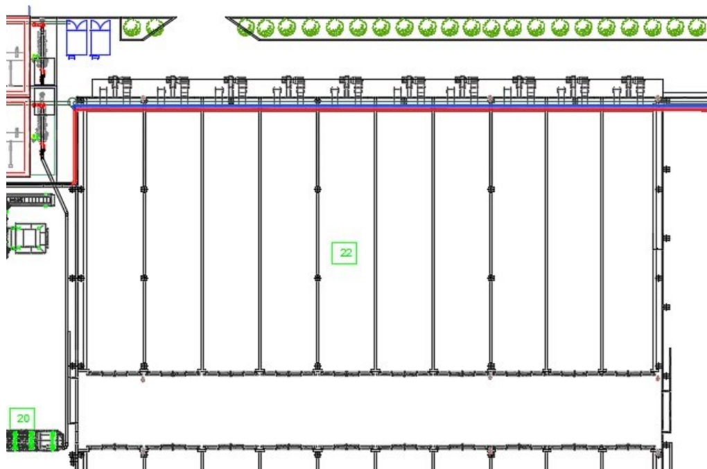
Figura 26: biocelle di maturazione
