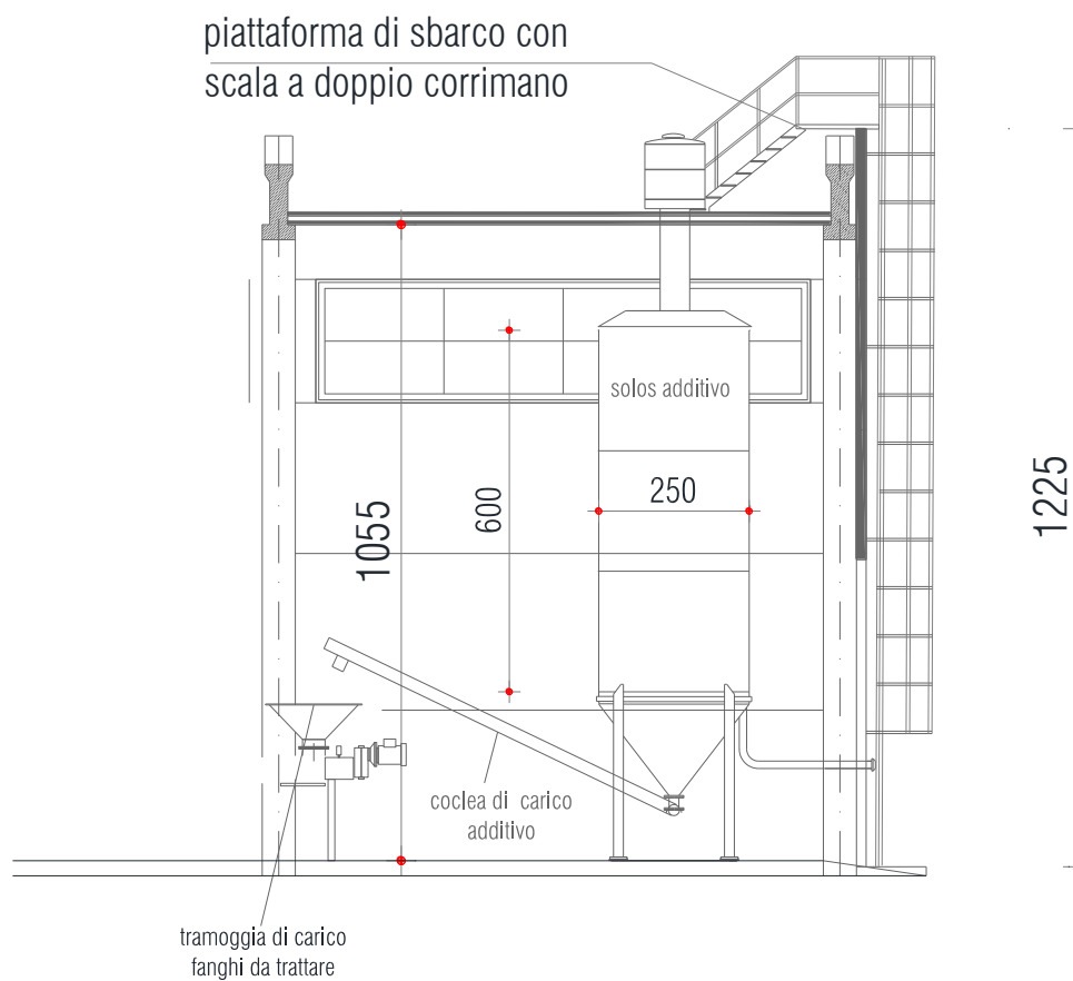
Fig. 10 - impianto di miscelazione e coclea di carico dell'additivo
