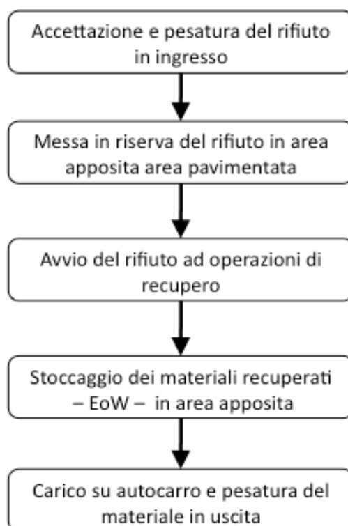
Figura 1: Schema a blocchi del processo di recupero dei rifiuti speciali non pericolosi
