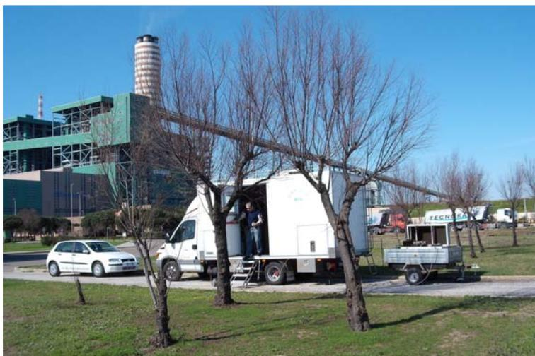
*Fig. 3 – ENVILAB presso la centrale elettrica di Cerano. La ciminiera della centrale (a 0.7 km) è stata usata come bersaglio topografico.*
