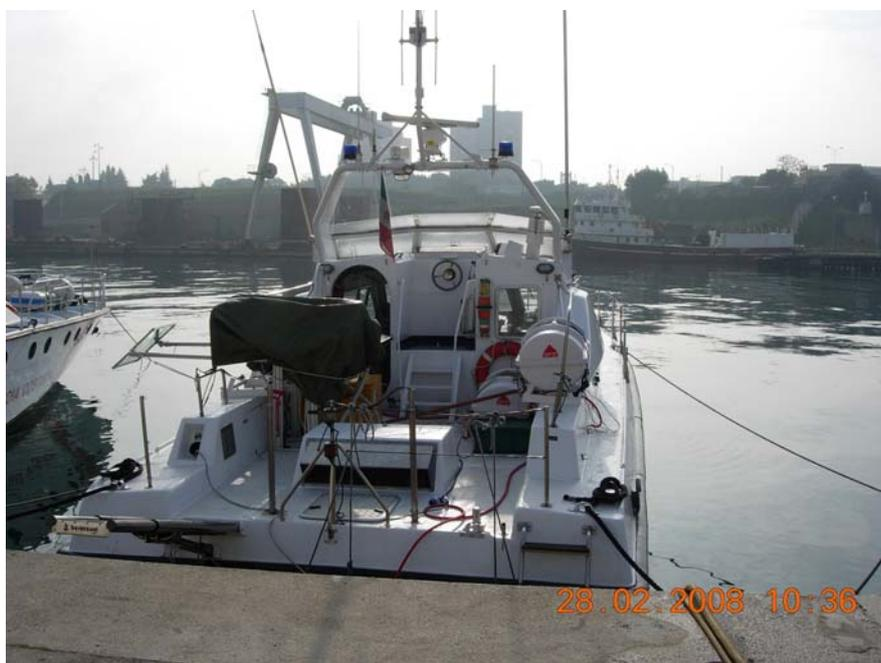
Figura 2. Apparato Lidar fluorosensore (a sinistra) installato sulla motovedetta della Guardia Costiera di Brindisi.
