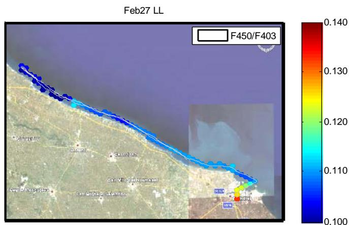
Figura 7. Distribuzione del CDOM [mg/l] con emissione F450 misurata con il Lidar Fluorosensore [27/02/08].
