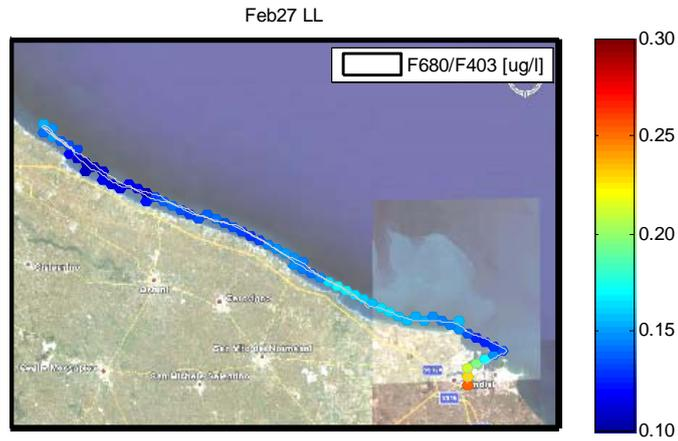
Figura 18. Distribuzione della biomassa [ $\mu\text{g/l}$ ] con emissione F680 misurata con il Lidar Fluorosensore [26/02/08].
