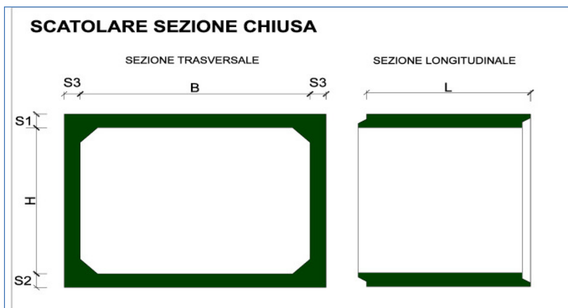
Figura 2.4 -Sezione tipo dello scatolare in c.a.
